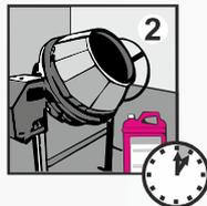
**2** При работе на стационарных бетоносмесителях добавку следует вводить через дозирующее устройство вместе с водой на стадии приготовления смеси. После введения добавки необходимо обеспечить достаточное время перемешивания. Рекомендуемая температура бетонной или растворной смеси перед началом работ не менее +15°C.
