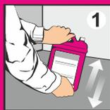
**1** Добавка готова к использованию. Перед применением материала взболтайте его. При ручном приготовлении раствора добавляйте добавку в воду для затворения перед загрузкой сухой смеси.
